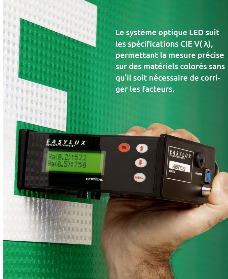
Le système optique LED suit les spécifications CIE V( $\lambda$ ), permettant la mesure précise sur des matériels colorés sans qu'il soit nécessaire de corriger les facteurs.
