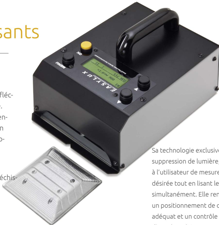
Sa technologie exclusive de suppression de lumière, permet à l'utilisateur de mesurer la zone désirée tout en lisant les résultats simultanément. Elle rend possible un positionnement de champ adéquat et un contrôle d'angle d'entrée précis.
