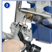
3 Pompayı gevşetmek ve kartuşu çıkarmak için çerçevenin altıgen bağlantı elemanını kullanın
